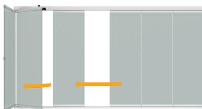
Leichtes Schieben und Drehen der einzelnen Elemente
